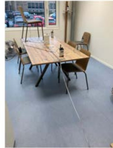
Figuur 4.2: Plaatsing van sensoren, ventilatoren en CO 2 -injectie
